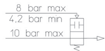
Schema di funzionamento nella configurazione semplice effetto normalmente aperto Spring return Normally open VIP Working plan
